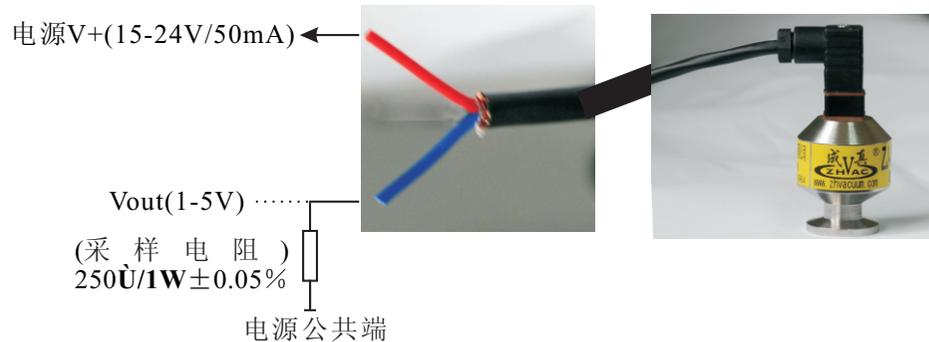
1、红色接输入电源V+：15-24V直流(电流不小于100mA，电压波峰值不大于0.5%)
